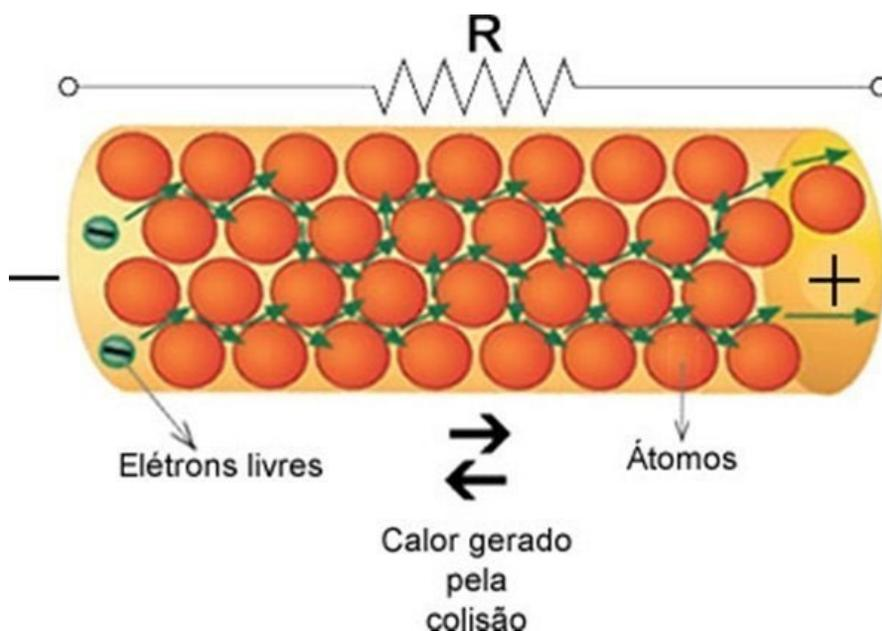
É a capacidade física de um corpo qualquer se opor à passagem de corrente elétrica mesmo quando existe uma diferença de potencial aplicada, capacidade calculada pela Primeira Lei de Ohm, e, segundo o Sistema Internacional de Unidades, é medida em ohms.
