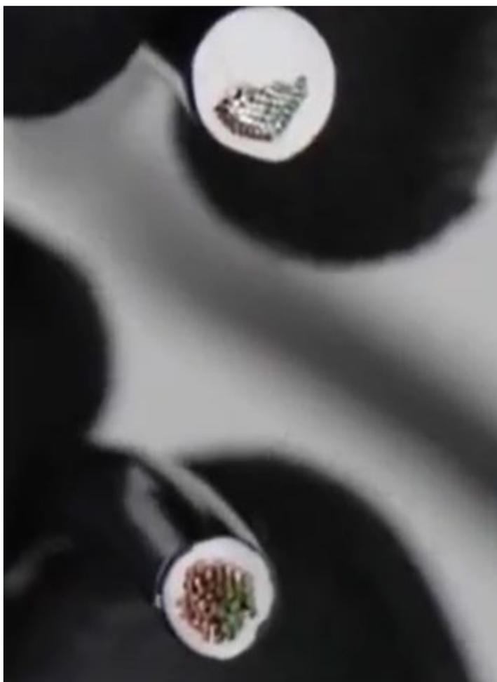
Choques elétricos, curtos-circuitos, sobrecarga elétrica e superaquecimento da instalação elétrica são algumas das preocupantes consequências que um cabo desbitolado pode provocar. Conheça os principais problemas:
